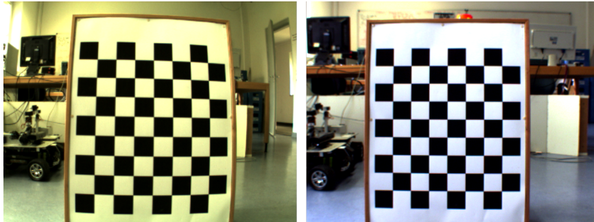
Abbildung 3.3: Unterschiedlich starke Verzerrung bei verschiedenen Kameras
