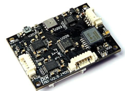
Abbildung 2: Die in unseren Quadrocoptern verwendete IMU mit ARM7 Mikroprozessor
